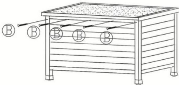
**3. Installare il tetto utilizzando le viti (B) x 5**
