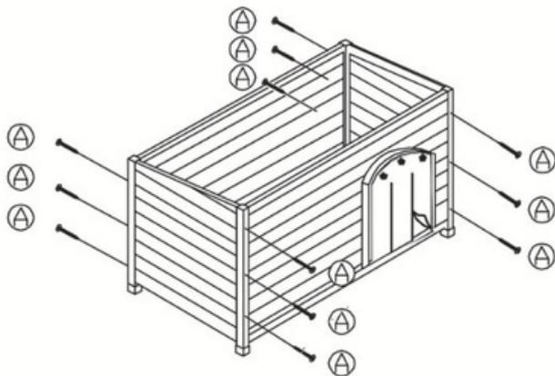
**1. Fissare i pannelli laterali ai pannelli anteriore e posteriore utilizzando 12 bulloni e dadi (A)**
