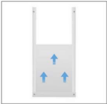
3. Fissare l'asta di alluminio destra e la barra in basso al pollaio. Spingere la porta manualmente per assicurarsi che scorra senza intoppi.
