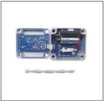
4. Aprire il pannello frontale del controller ed estrarre il supporto della batteria. Installare 4 batterie AA nel supporto della batteria e ricollegarlo.
